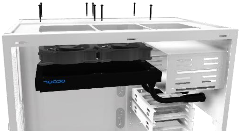
ventilateurs à suction
